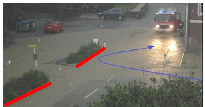
Weiters befindet sich im Überflutungsbereich bei der Buchenhecke ein Erdwall, welcher das Hochwasser weiter aufstaut und den Abfluss stört.
